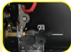
ВСІ ЧАСТИНИ МЕХАНІЗМУ ПОДАЧІ ЗВАРЮВАЛЬНОГО ДРОТУ ВИГОТОВЛЕНІ З МЕТАЛУ
